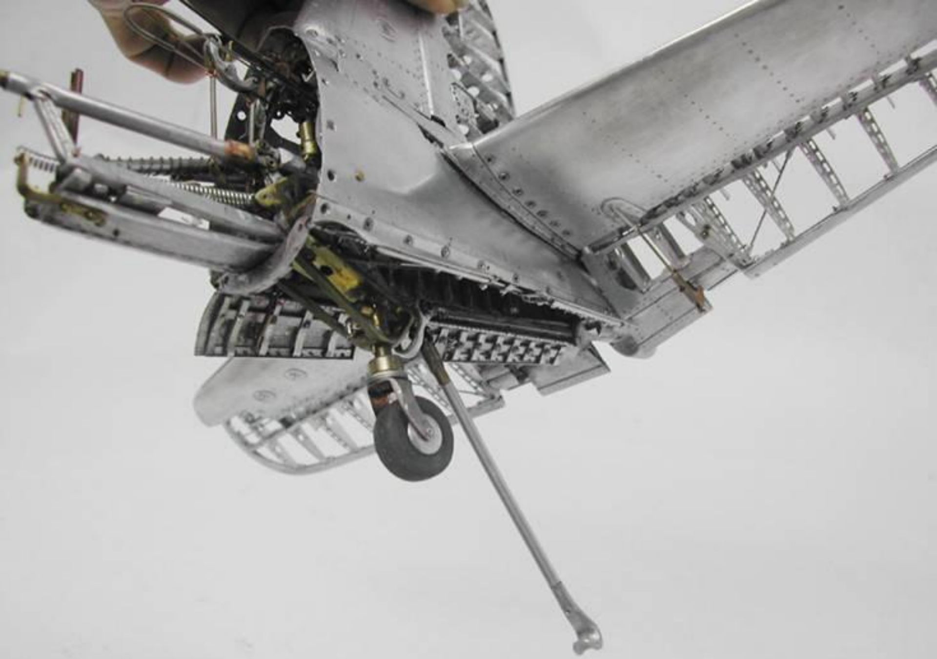
La roulette arrière et la crose d'appontage fonctionnent, elles aussi.
